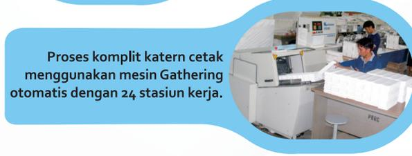
Proses komplit katern cetak menggunakan mesin Gathering otomatis dengan 24 stasiun kerja.
