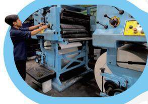
Mencetak diatas kertas tipis (24-40 gsm) dengan menggunakan mesin cetak gulungan yang berkecepatan tinggi.
