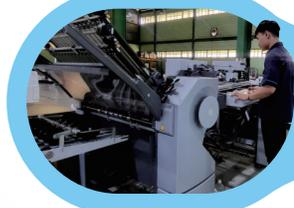
Proses lipat sheet menggunakan mesin Stahlfolder.
